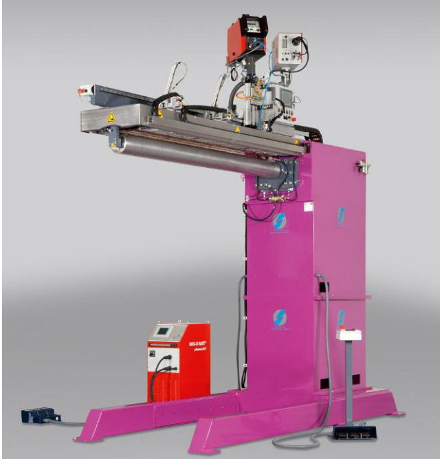
Bild 4: Höhenverstellbare Spannbank (Werksbild Schnelldorfer Maschinenbau)
